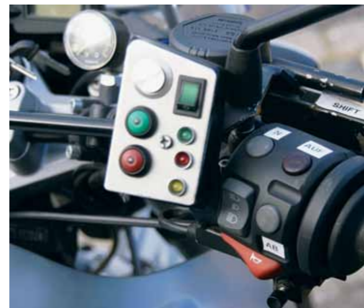
Kontrollenheten er plassert ved styret og inneholder aktivering for F.B.S., og en elektronisk pneumatisk styring for girskiftet.
