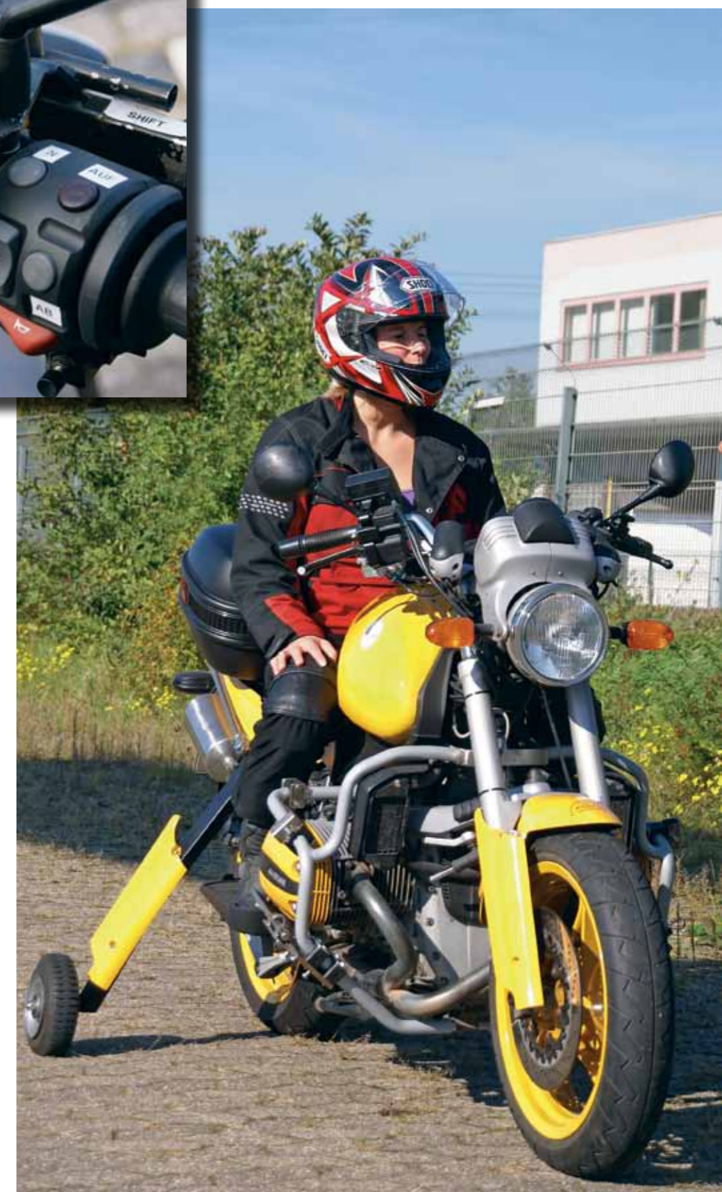
Systemet virker helt enkelt ved at støttehjul foldes ut når det er behov for dem.
