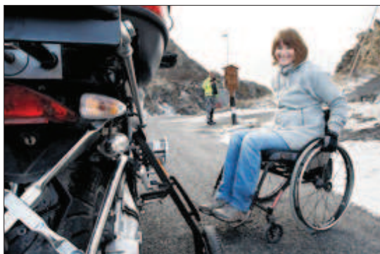
Støttehjul. Motorsykkelen er ombygd i Tyskland. Den har støttehjul som er nede når den står i ro og går i kryppfart. Foto: Tom Melby
