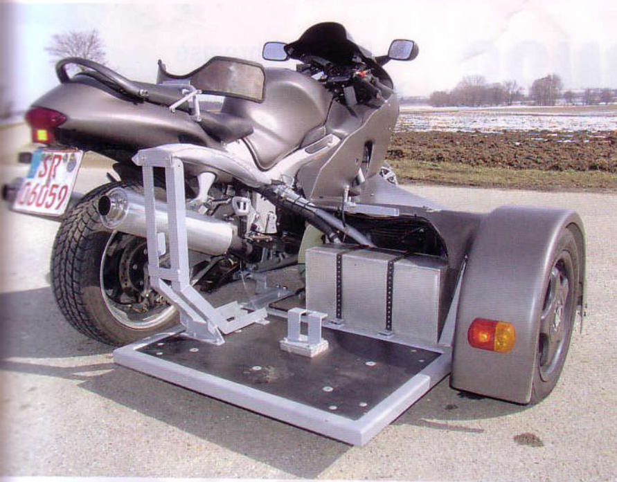
Beiwagen der Zusatztank mit 24 Litern und die Halterung für den Rollstuhl.
